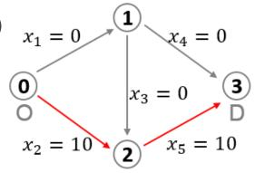
③②によりリンク交通量  $X^{(1)}$ が決まる  $X^{(1)} = \begin{pmatrix} x_1 \\ x_2 \\ x_3 \\ x_4 \\ x_5 \end{pmatrix} = \begin{pmatrix} 10 \\ 10 \\ 0 \\ 10 \end{pmatrix}$
